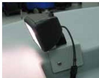
Arbeitsscheinwerfer vorne Arbeitsscheinwerfer leuchten den gesamten Arbeitsbereich der Maschine vorne und hinten aus.
