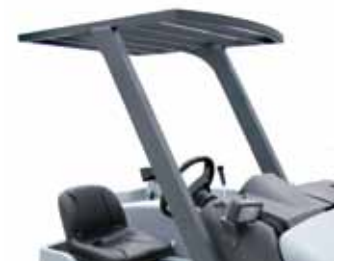
Fahrerschutzdach Schützt den Fahrer, besonders für industrielle Anwendungen.
