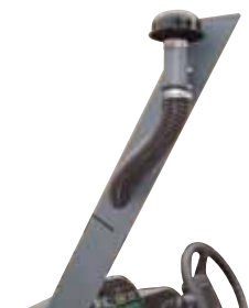
Erhöhte Luftansaugstutzen Für bessere Luftqualität im Vergaser; besonders für staubige Einsätze
