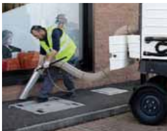
Zusatz Ansaugrohr Für Laubsaugung und schwer zugängliches Sauggut.
