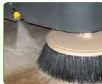
DustGuard™ Kit bindet mit einem feinen Wassernebel Staubschwebeteilchen direkt beim Entstehen.
