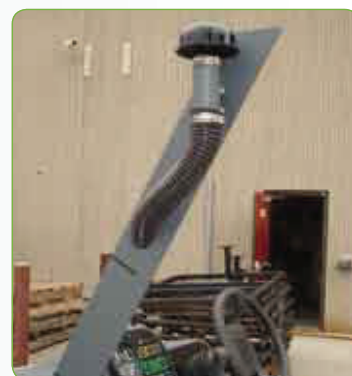
Erhöhte Luftansaugung Für stark verschmutzte und staubige Flächen.
