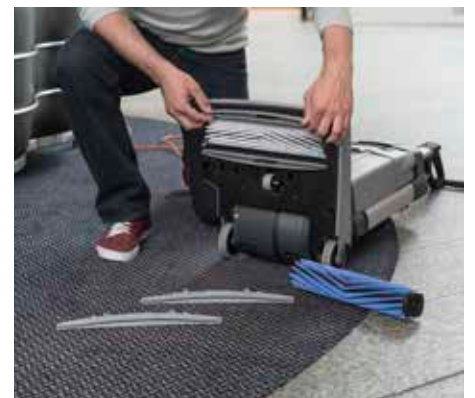
Teppich-Walzenbürste mit Teppichsaugleisten: für Reinigung von Teppichbelägen und Fleckenentfernung. Walzenbürste wie auch Saugleisten sind werkzeuglos wechselbar.
